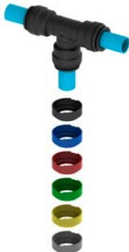
I copricolletti evitano la rimozione accidentale o la manomissione del tubo. Il tubo può essere inserito con il copricolletto già fissato sul raccordo oppure il copricolletto può essere aggiunto in un secondo tempo. Il copricolletto è facilmente rimuovibile quando necessario ed è disponibile in una varietà di colori che permettono la codifica.
