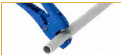
Tagliare il tubo perpendicolarmente, rimuovere sbavature e spigoli vivi. Assicurarsi che il diametro esterno sia esente da rigature. Nel caso il tubo sia di materiale morbido o sottile si raccomanda l'uso dell'inserto per tubo.
